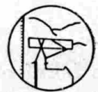
Obr. 212. Zorné pole invertního telemetru.
