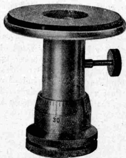
Obr. 261. Ruční mikrotom. Řezy se provádějí ruční břitvou a šroubem mikrotomu posouváme řezanou hmotou o potřebnou tloušťku řezu.
