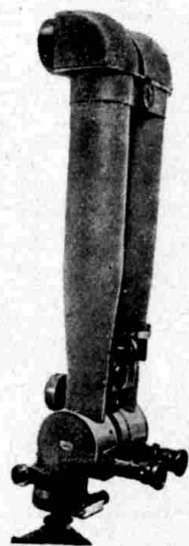
Obr. 178. Úhlový dalekohled 15x.
