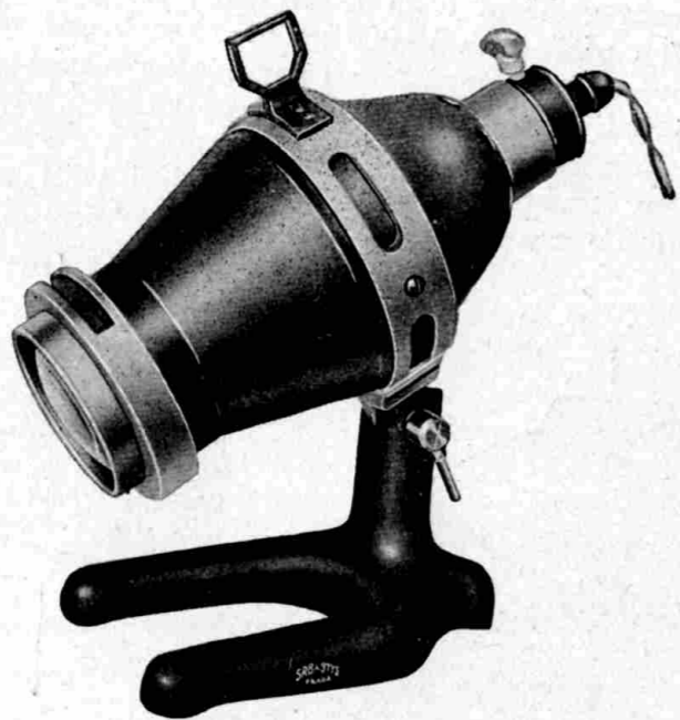
Obr. 278. Mikrolampa dle profesora Šikla s bodovou žárovkou.
