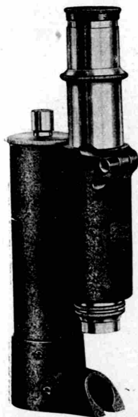
Obr. 294. Dílenský kontrolní mikroskop se suchou baterií v držáku, ve kterém je osvětlovací zařízení, zvětšení 40 x. Mikrometr v mikroskopu umožňuje měření na \frac{1}{100} m/m.
