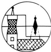
Obr. 8.3.13 Jiná úprava zorného pole koincidenčního dálkoměru doposažená hranolovým blokem podle obr. 8.3.10
