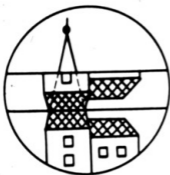
Obr. 8.3.12 Vzhled společného zorného pole koincidenčního dálkoměru upraveného podle obr. 8.3.11
