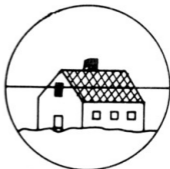
Obr. 8.3.3 Zorné pole koincidenčního dalkoměru se vzpřímenými obrazy
